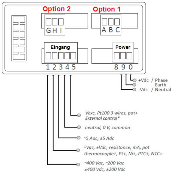
Wie von Sicherheitsbestimmungen EN-61010- 1 gefordert fügen Sie eine Sicherung an der Stromleitung, mit den Werten:
