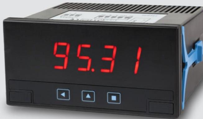
Schleifengespeistes digitales Einbaumessgerät, 48x96mm. Zum Anschluss an 4/20 mA Schleifensignale. Das Instrument versorgt sich aus dem Messkreis. Hervorragende Lesbarkeit mit vier rote 7-Segment-LEDs.
